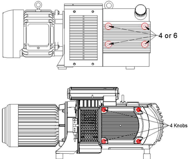
El elemento filtrante debe comprobarse entre 40 y 200 horas. Los elementos se deben soplar con aire comprimido de adentro hacia afuera. Se debe sentir el aire a través del filtro / elemento. El elemento debe ser reemplazado si está sucio u obstruido.
