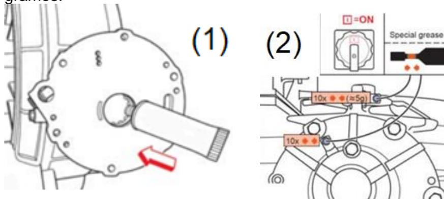
Bombas 7.5 – 15 HP: Engrase el rodamiento a las 3000 horas de funcionamiento de la bomba. Los accesorios para realizar el engrase se encuentran detrás de la tapa transparente de la cámara del filtro (1).
