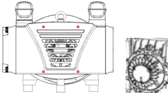
Limpie el exceso de grasa del eje del rotor
